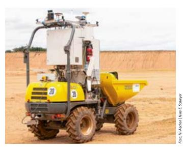
Kipp-Element: Ein von FH und RWTH Aachen ausgestattetes Bergbaufahrzeug ist in der Lage, selbstständig über und unter Tage zu arbeiten.
