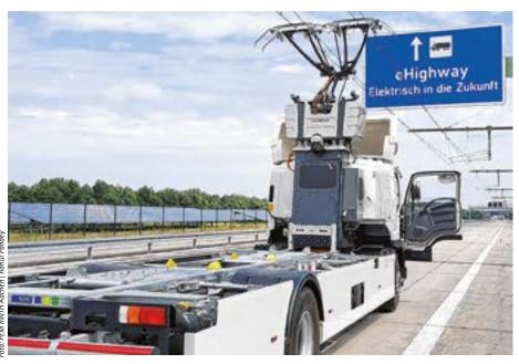
Drahtseilakt: Ein Elektro-Lkw-Prototyp aus Aachen hat seine erste Probefahrt an der Oberleitung unter realen Bedingungen bestanden.
